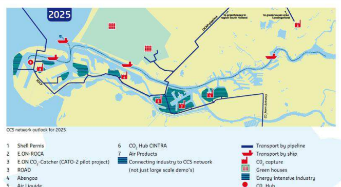
Figure 33 - Projet de capture, collecte, stockage et réutilisation de CO 2 du Port de Rotterdam
