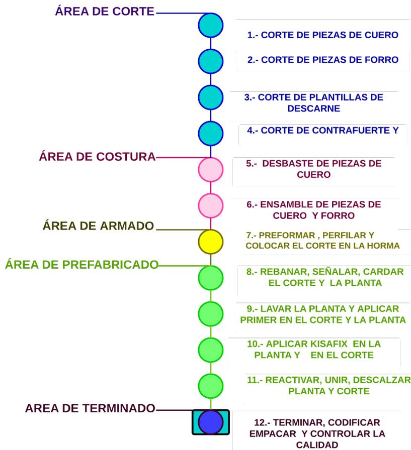
**Figura No. 4.** Diagrama de operaciones del proceso de producción.
