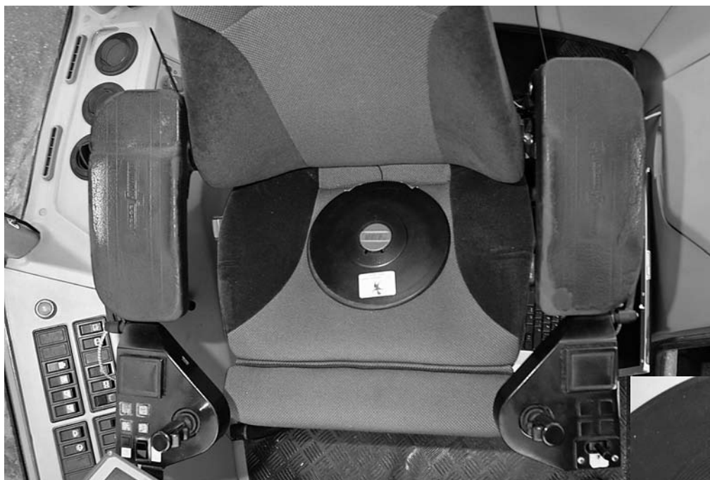
Figur 9 (ovan). Vibrationsdosimetern monterad i sittplattan placerad på stolsdynan.
