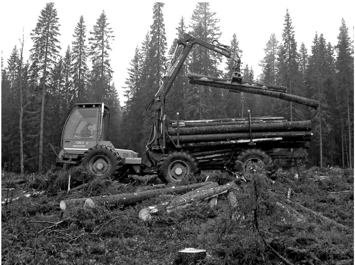
Figur 5. Hybridskotaren El-Forest i skotningsarbete.
