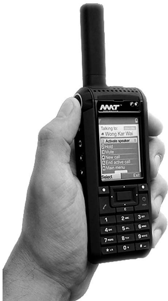
Figur 1. En s.k. ruggad telefon för det kommande digitala 450-nätet.
