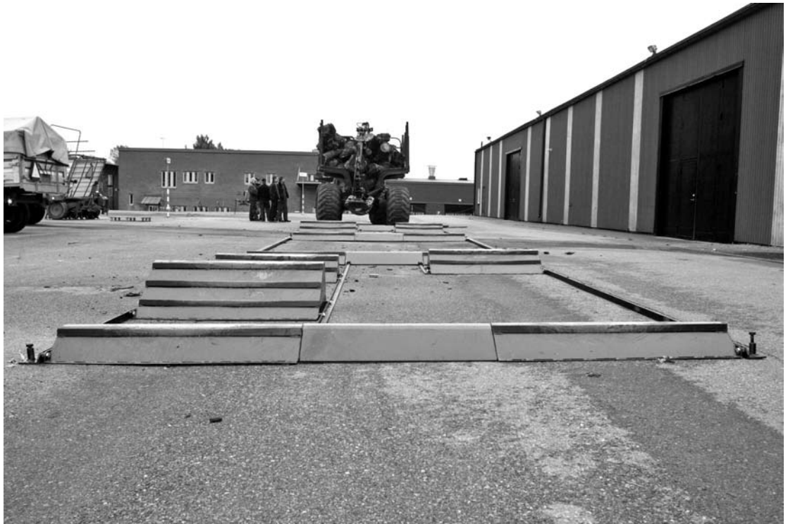
Figur 7. Hinderbanan består av 2 st 6-meterssektioner med 15, 25 och 35 cm höga hinder. Varje sektion har 6 hinder.
