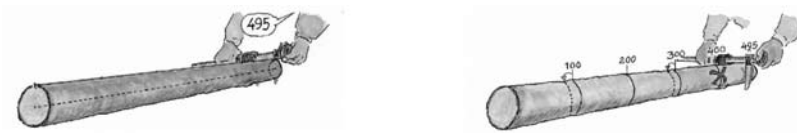
Figur 5. Längd och diametermätning av provträdens stockar, normalt en diametermätning per meter.
