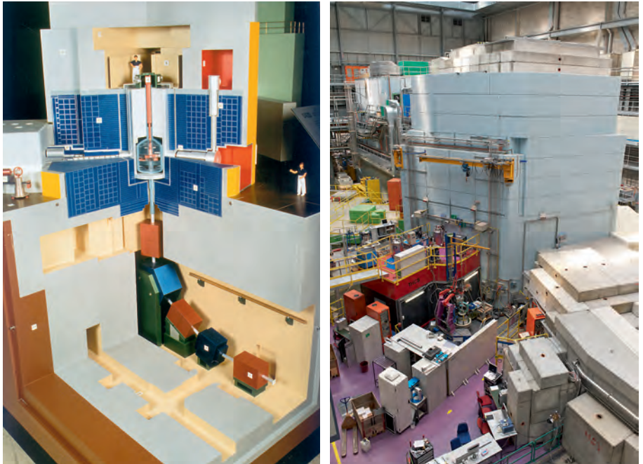
Bild 9.4.3 Schnittbildmodell des SINQ-Target-Blocks mit Einschuss des Protonenstrahls aus der Vertikalen von unten nach der Führung des Protonenstrahls über etwa 200 Meter in Hochvakuumssystemen. Das Spallationstarget befindet sich in der Mitte der Abschirmeinheit. Targetmaterial: Blei in Zirkonhüllen, Kühlmittel: Schwerwasser, Wärmeleistung etwa 1 Megawatt, Kalte Quelle: D_2 bei 25 K (flüssig). (Paul Scherrer Institut)
