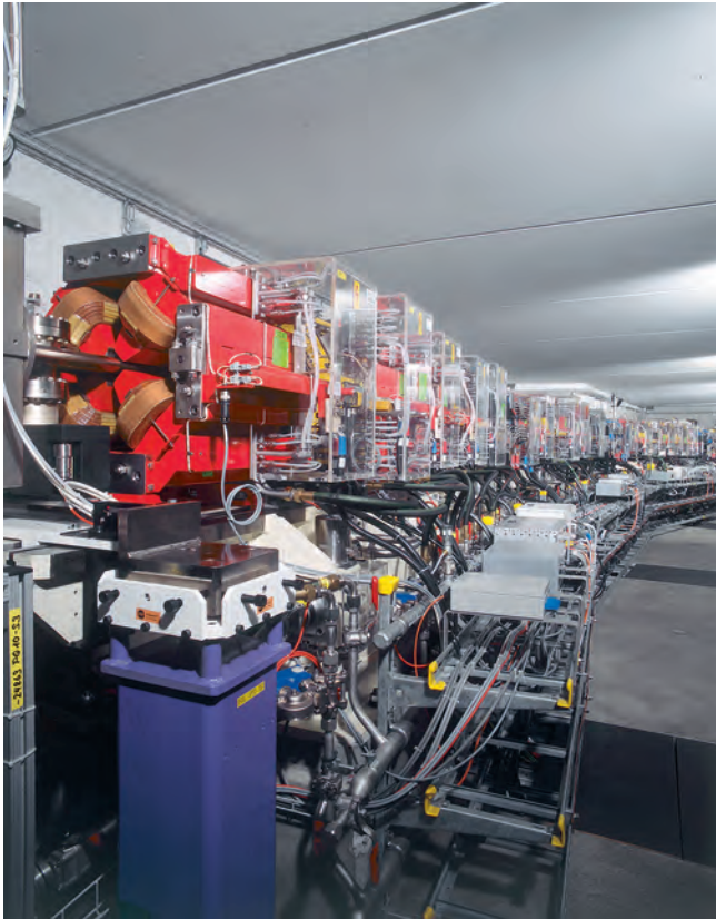
Bild 9.4.5 Blick in den Tunnel der Synchrotron-Lichtquelle Schweiz (SLS): 600 Magnete sind im Einsatz. Die einen halten die Elektronen auf ihrer Kreisbahn, weitere zwingen sie zusätzlich auf sehr enge Slalombahnen. Dadurch senden diese Elektronen Synchrotron-Strahlung entlang ihrer Bewegungsrichtung aus. (Paul Scherrer Institut)
