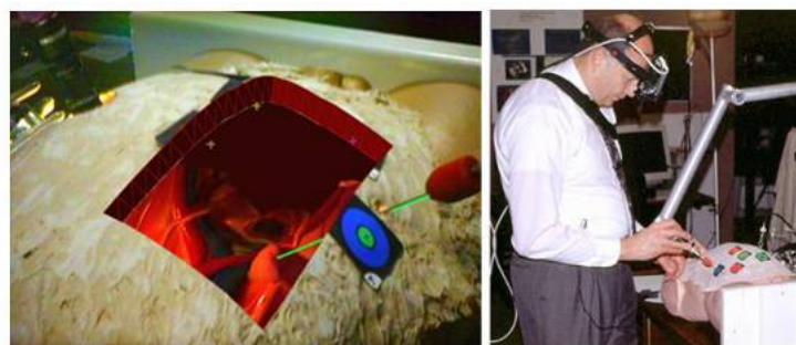
FIG. 2.6: Vue dans le casque utilisé pour la laparoscopie (à gauche) le dispositif en phase de test (à droite)
