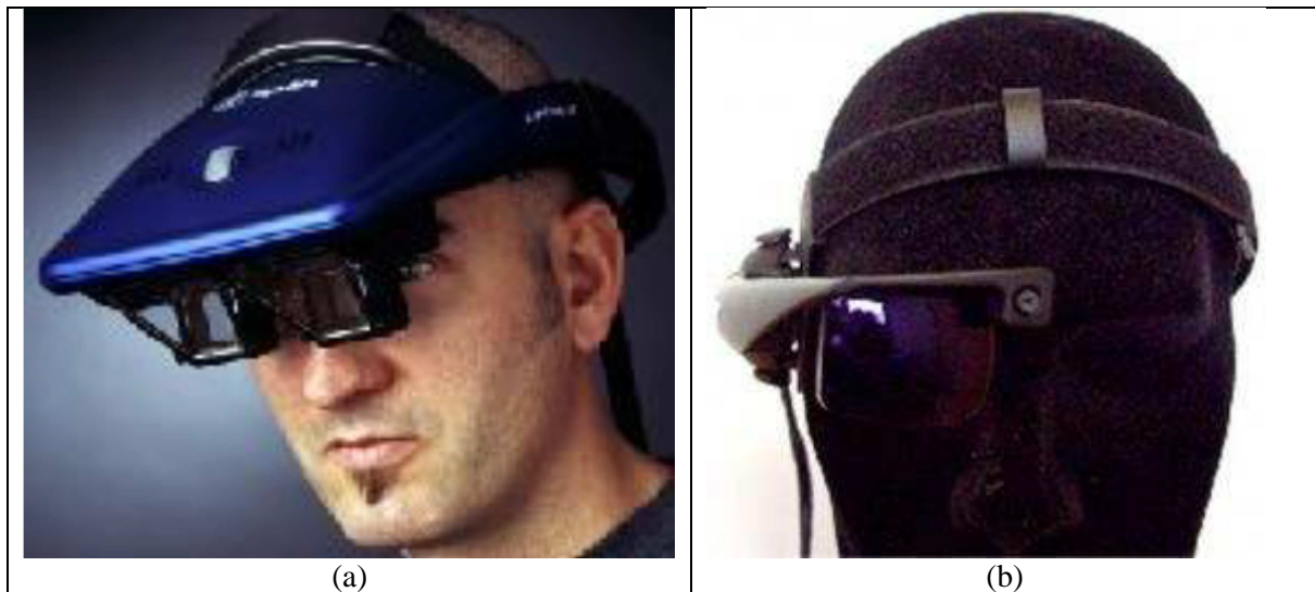
Figure 2.3 : Deux exemples de lunettes see-through optiques : AddVisor 150 développé par SAABtech (a) et périphérique développé par Laster Technologies (b)
