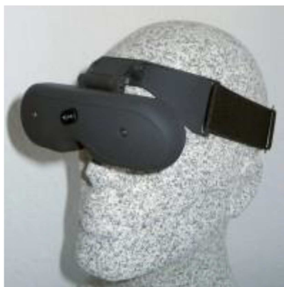
Figure 2.4 : Exemple de lunettes see-through vidéo développé par TriVisio
