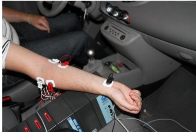
Fig. III-9 : Branchement des électrodes pour l'analyse des EMG
