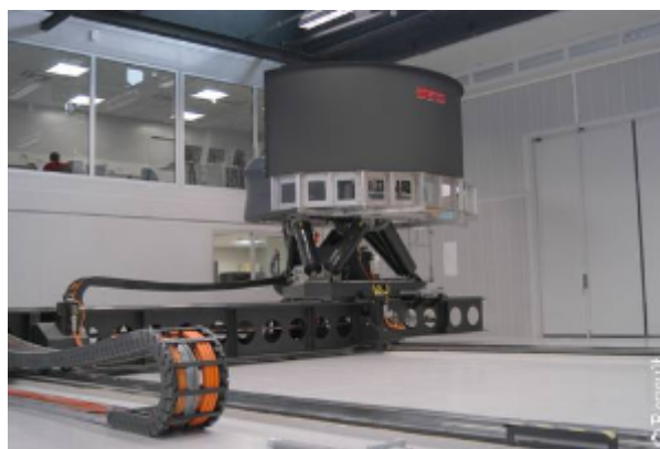
Fig. I-8. : Simulateur de conduite ULTIMATE Renault
