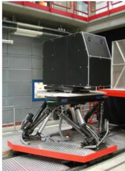
Fig.I-9. : Simulateur de conduite MARS
