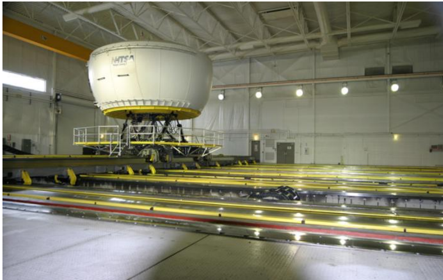
Fig. I-10. : Simulateur de conduite NADS-1 [NAD10, Lev12].
