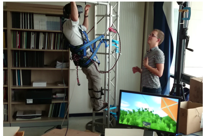
Figure 1: Simulateur de travail en hauteur. L'utilisateur doit monter sur une échelle réelle synchronisée avec une échelle virtuelle placée en hauteur dans l'environnement virtuel et attraper un cerf-volant en lâchant ses mains de l'échelle.
